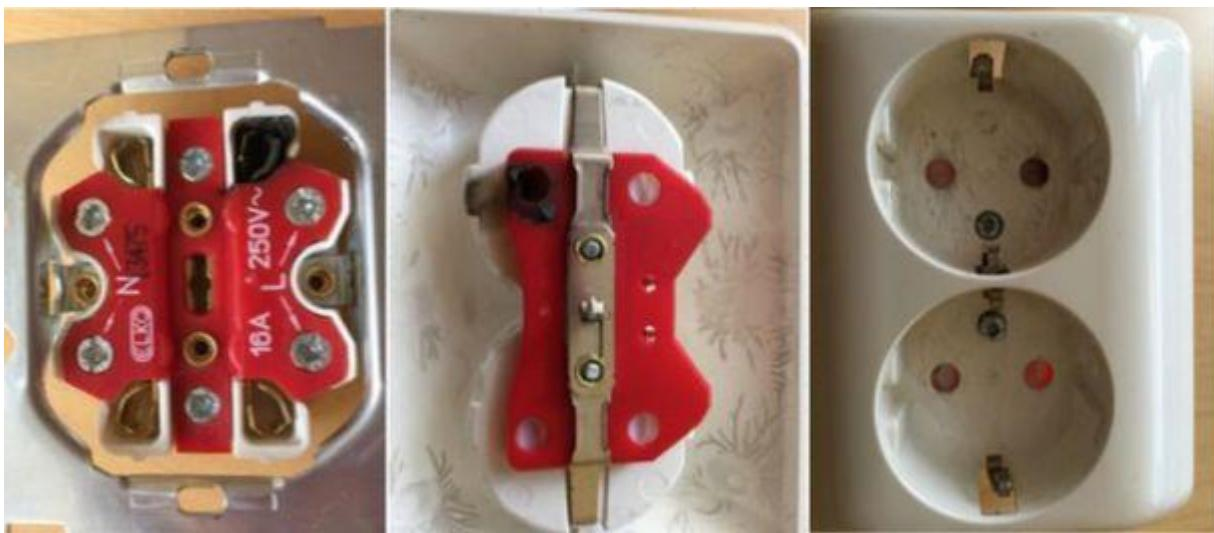
Bildene viser en ny kontakt hvor det utviklet seg varmegang etter kun 4 måneder, ladestrømmen var 10A. Når vi ser fronten av kontakten er det tydelige spor etter lysbuer fordi ladekabelen ble trukket ut uten av ladingen var avsluttet.
